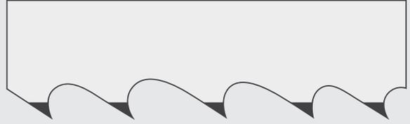
O perfil padrão de dente é adequado para cortar materiais de variada gama, desde aço estrutural até materiais de difícil corte.
