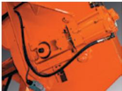
**Tensionador hidráulico da lâmina**
