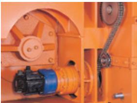
**A Pressão de Corte é** controlada pelo servomotor, através do redutor com engrenagem planetária, para que a taxa de corte possa ser ajustada com precisão.
