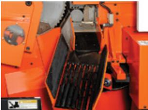
**3ª morsa de alimentação com servo motor.** Máximo aproveitamento da peça cortada. Evita sobras e perdas desnecessárias
