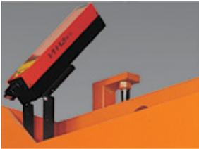
**O Dispositivo de Projeção de Laser** localizado no topo da estrutura da máquina projeta o roteiro da linha de corte para facilitar a medição e, graças à mesa de içamento hidráulico, o material a ser cortado pode ser manobrado facilmente.
