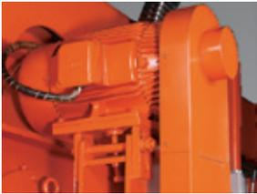
**O Redutor com Engrenagem Planetária** assegura maior eficiência e torque significativamente mais alto, proporcionando economia de energia elétrica, menor vibração e maior vida útil à máquina.
