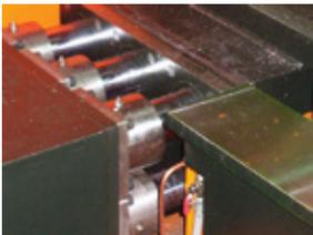
**O Trocador Automático de Lâmina** reduz muito os esforços e o tempo para troca da lâmina, quando necessário. Durante a troca, a lâmina pode passar através dos braços retráteis no chassi principal.
